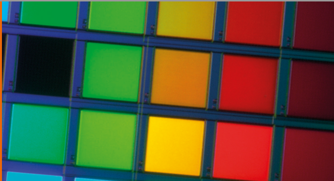
1 Mikroskopaufnahme eines Farbsensorchips
